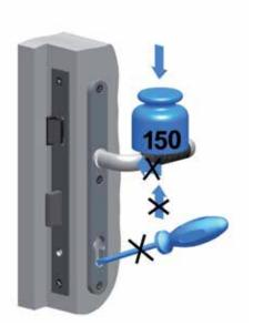
Der Drücker darf nur im normalen Drehsinn belastet werden. In Betätigungsrichtung darf auf den Drücker maximal nur eine Kraft von 150N aufgebracht werden.
