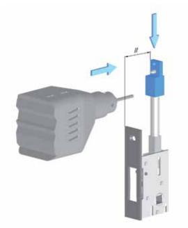
Treibriegelstange mit **parallel** zum Stulp aufgestelltem Verbindungselement durchbohren (Bohrer ø 2,5 mm) Drill shoot bolt and connector, which has been aligned **parallel** to the forend (drill ø 2.5 mm).
