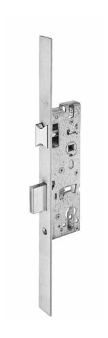
Lieferbar für Art. 1438, 6667, 6677, 6657, 7667, 7677, 7687 spezieller Stulp für Renovierungs- und Reparaturbedarf in Sonderlänge 380 mm mit Bohrnut auf der Stulprückseite zur individuellen Anpassungen an die Gegebenheiten vor Ort, Stulp Edelstahl rostfrei. Da die Stulpbefestigungslöcher nicht vorgegeben sind, entfällt die Zulassung für EN 12209
