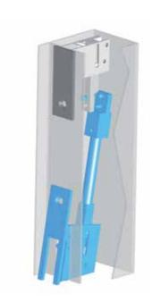
Gegenkasten und Umlenkschloss wie dargestellt aufstecken. Attach panic keep and door selector as illustrated above.
