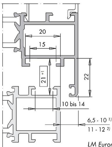
Für das Zubehör zu den SIEGENIA-AUBI - Beschlägen LM gelten die Angaben zur LM Euronut bei Aluminiumprofilen für Fenster und Fenstertüren.
